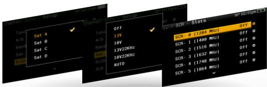
Recebe sinal de qualquer satélite, necessário configurar os parâmetros de SCR e DiSEqC, assim como a alimentação dos LNBS.
